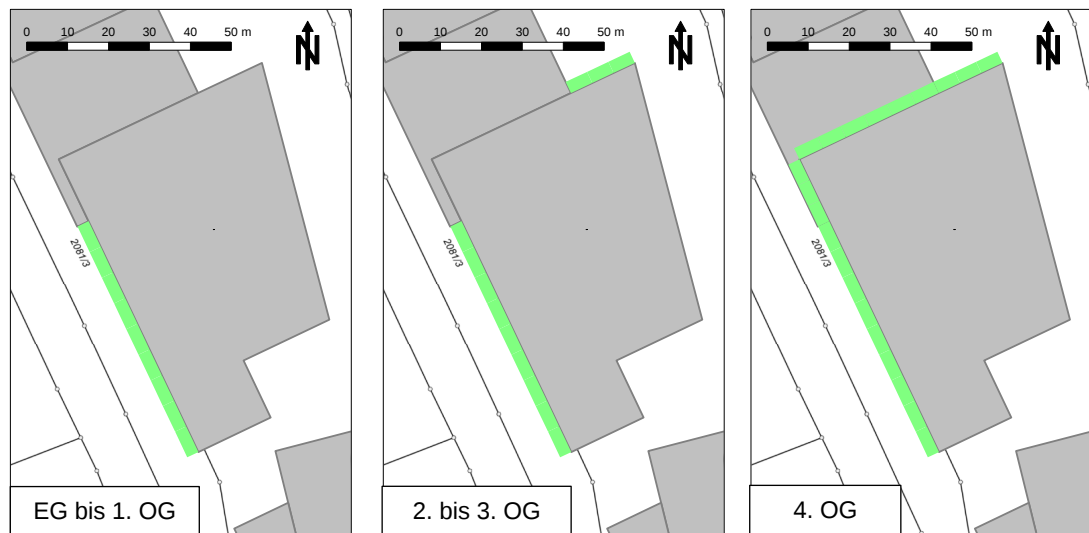
Abbildung F. Fassaden mit Überschreitung des Immissionsrichtwerts der 18. BImSchV für Pflegeanstalten durch Sportgeräusche.
