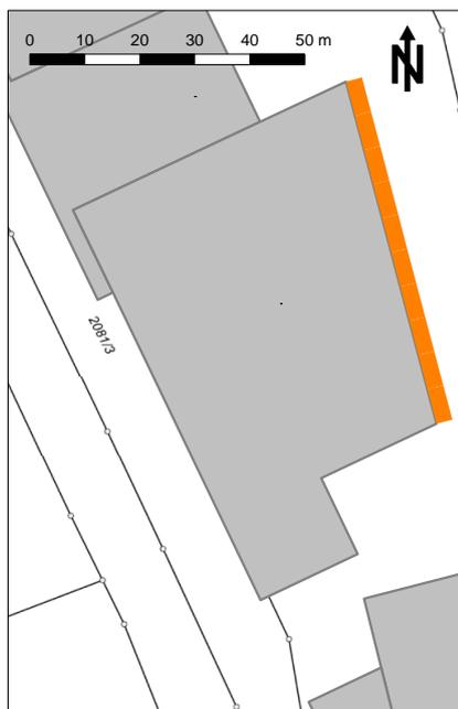
Abbildung A. Fassaden mit Anforderungen zu Schallschutzmaßnahmen (schalldämmte Lüftungseinrichtungen) für die Pflegebereiche innerhalb des Pflegezentrums bzgl. der Verkehrsgereusche.
