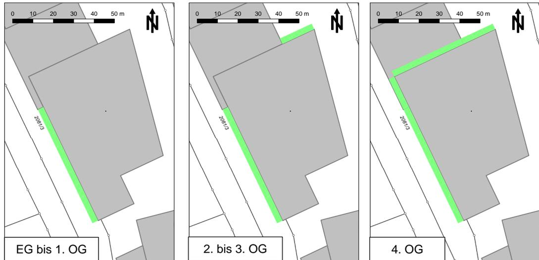
Abbildung 14. Fassaden mit Überschreitung des Immissionsrichtwerts der 18. BImSchV für Pflegeanstalten durch Sportgeräusche.
