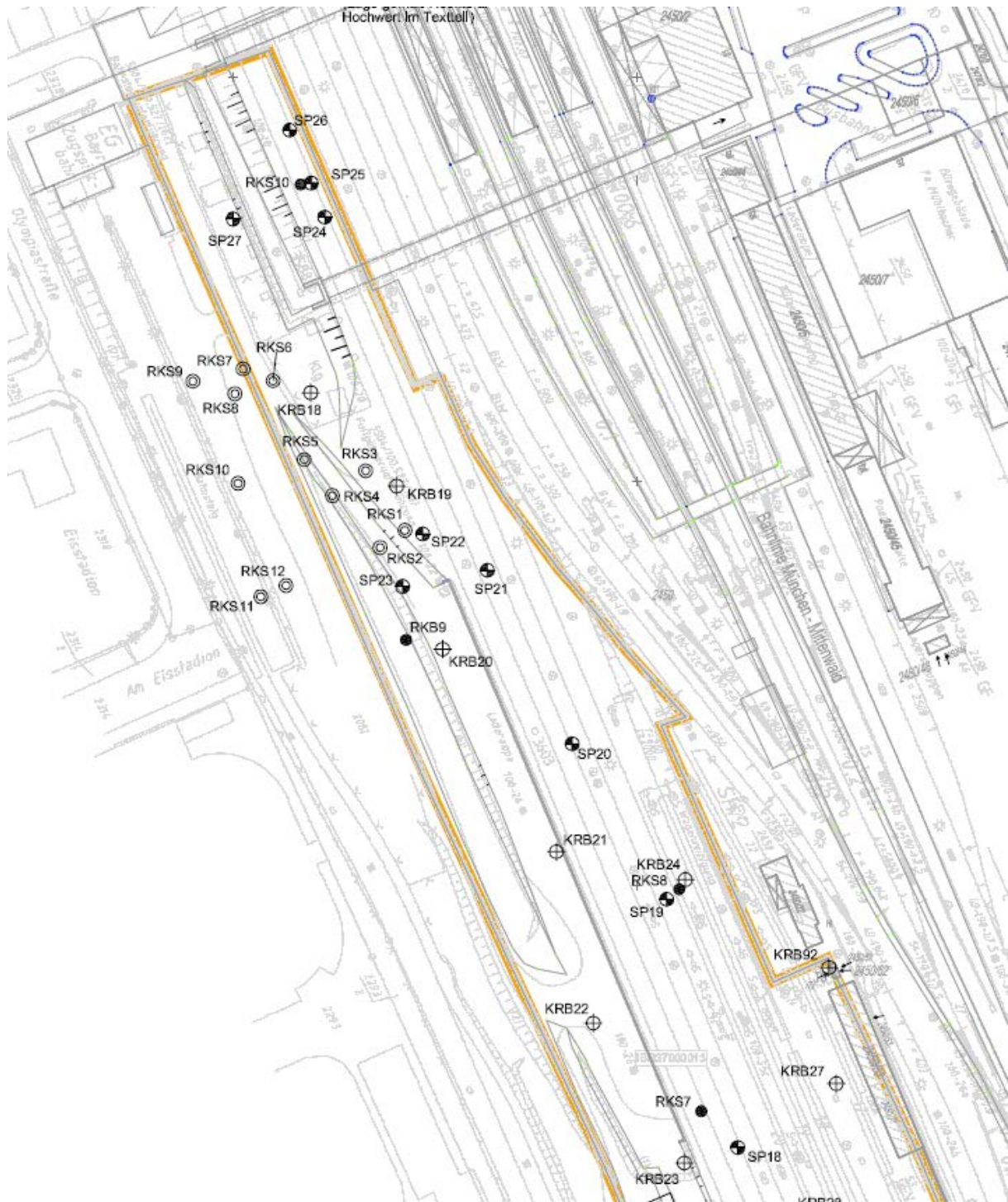
Abb. 17: Untersuchungsgebiet mit Lage der Sondierungen – Auszug aus der Altlasten- und abfalltechnische Untersuchung (SakostaCAU GmbH vom 15.02.2010), Darstellung unmaßstäblich
