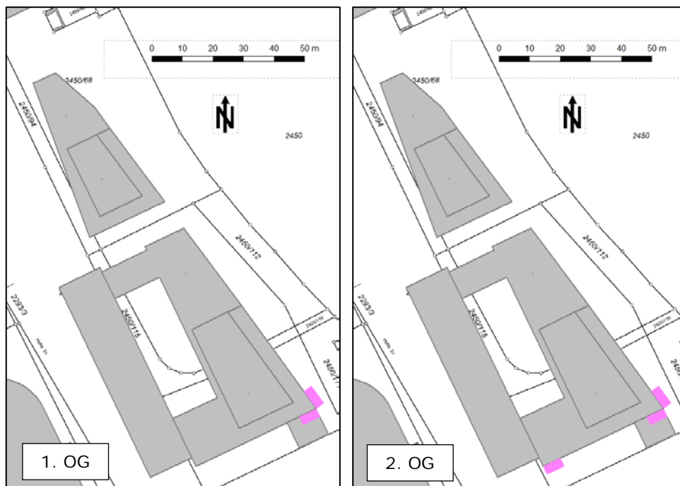
Abbildung B - Fassaden mit Überschreitung der Immissionsrichtwerte der TA Lärm durch Gewerbegeräusche
