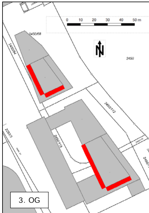
Abbildung C - Fassaden mit Überschreitung der Immissionsrichtwerte der 18. BImSchV durch Sportgeräusche (EG nicht dargestellt, da keine Wohnnutzung)
