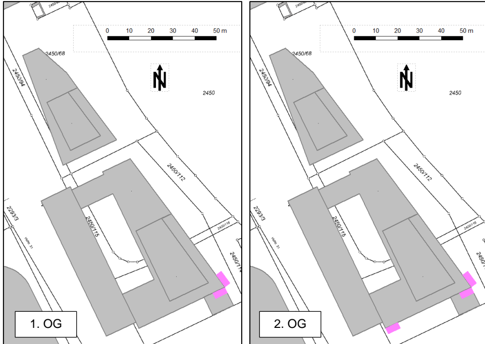
Abbildung B. Fassaden mit Überschreitung des Immissionsrichtwerts der TA Lärm nachts durch Gewerbegeräusche (EG nicht dargestellt, da keine Wohnnutzung).
