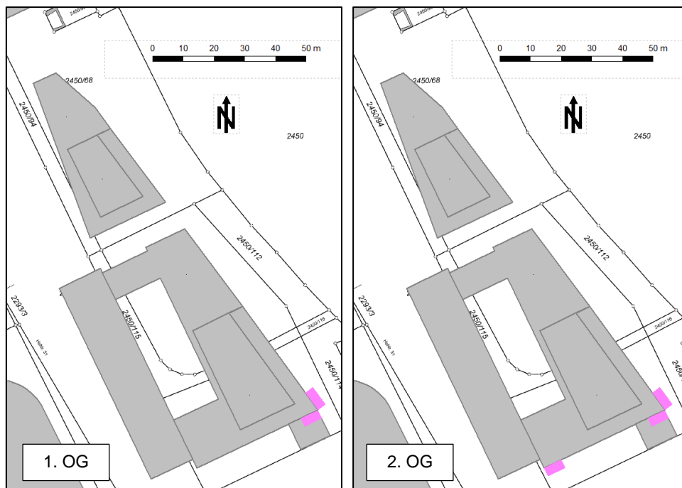
Abbildung 11. Fassaden mit Überschreitung der Immissionsrichtwerte der TA Lärm nachts durch Gewerbegeräusche (EG nicht dargestellt, da keine Wohnnutzung).
